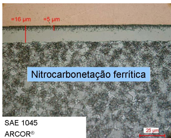
Fig. 3: Aspecto da camada de compostos após 1008 horas no teste de salt spray
