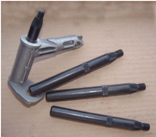
Fig. 8: Eixos de limpador de para-brisa tratados pelo processo CLIN
